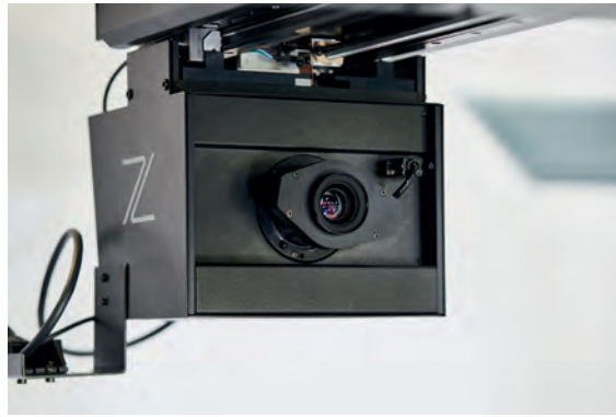
Für die Aufnahme kommt eine Giga Pixel-Kamera mit großem CMOS-Sensor zum Einsatz.
