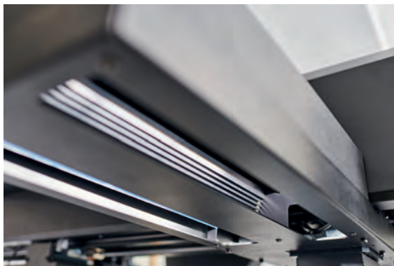
Das LED-Beleuchtungssystem bietet eine gleichmäßige Helligkeit im gesamten Scanbereich.
