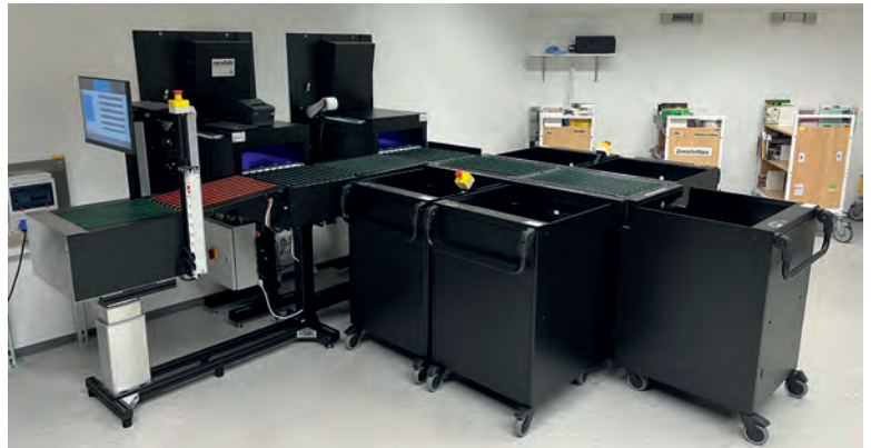
Stadtbibliothek Bayreuth: ergonomisch höhenverstellbare Mitarbeiterrückgabe an der Sortieranlage
