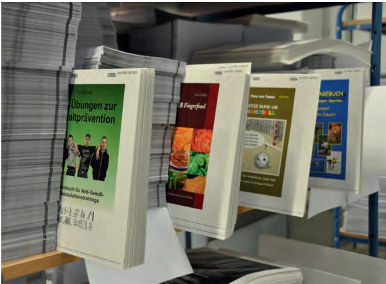
*Getrennt durch den Einband warten die Buchblocks auf die Weiterverarbeitung in der Bindemaschine (die, wenn man es genau nimmt, eigentlich eine Klebmaschine ist).*
