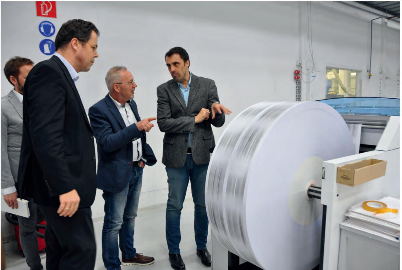
*Hocheffizient: Die Digitaldruckmaschine verarbeitet die Buchaufträge in rasantem Tempo hintereinander weg. Pro Minute werden um die 100 Meter bedruckt. Auf der Rolle sind acht bis zwölf Kilometer Papier. Sie wiegt etwa 900 Kilogramm. Die Erläuterungen von BoD-Vertriebsmanager Oliver Schnoor (r.) faszinieren den Leiter des b.i.t.verlages, Erwin König (m.) ganz offensichtlich. Links im Bild Dr. Gerd Robertz, Sprecher der BoD-Geschäftsführung, im Hintergrund BoD-Pressesprecher Thorsten Simon.*
