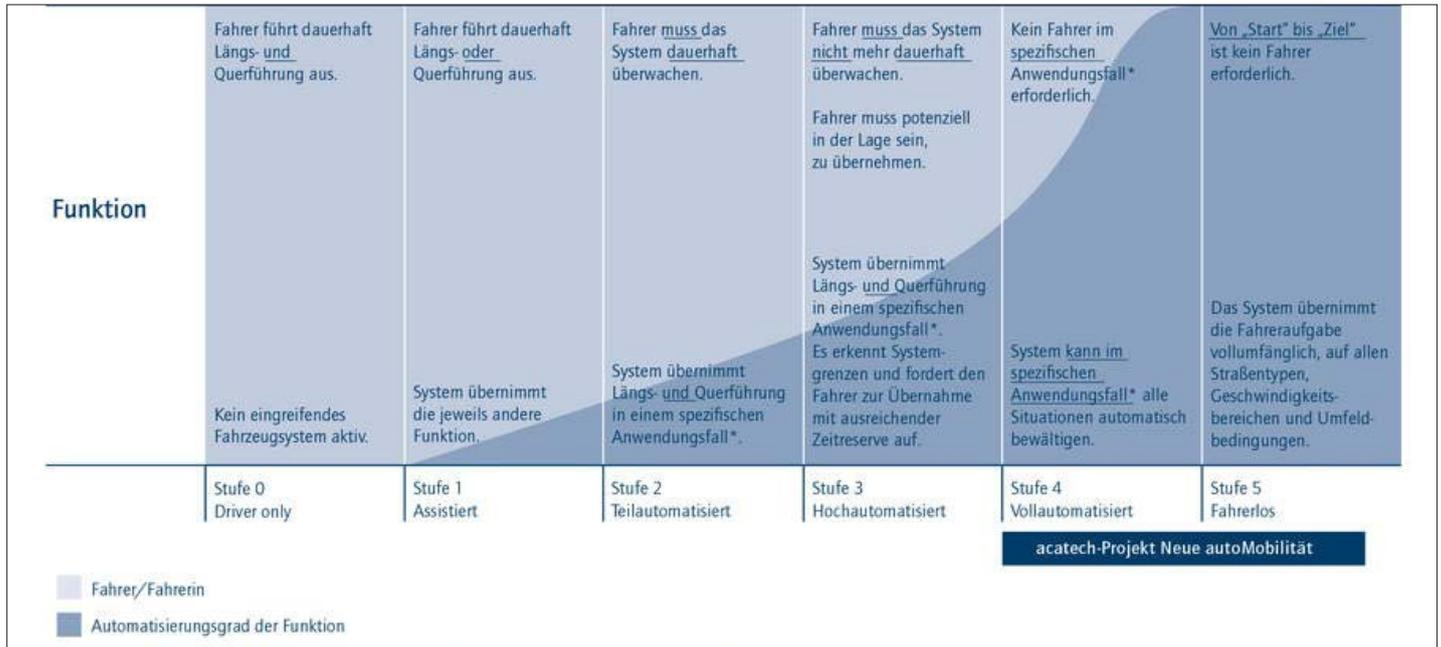
Abb. 2: Stufen der Automatisierung bei Assistenzsystemen im Bereich des automatisierten Fahrens
