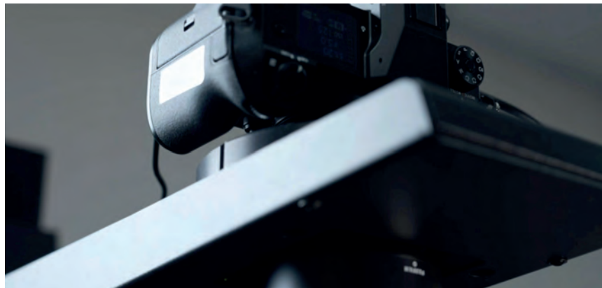
Der Zeutschel OS A1 setzt eine Kamera mit 100 Megapixeln ein.
