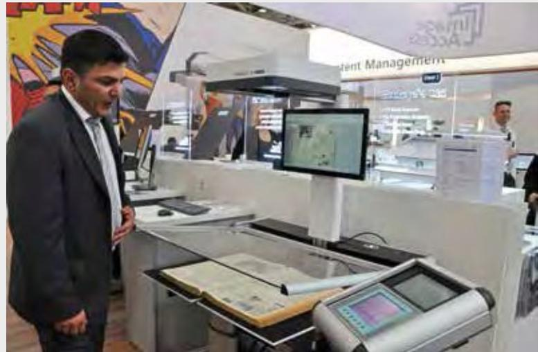
*ImageAccess stellte den größten Bookeye-Aufsichtsscanner aller Zeiten vor: Der A1+ Bookeye 4 V1A-C35 ist laut Hersteller „die professionelle Lösung für Digitalisierungsprojekte, die neben hoher Qualität und maximaler Produktivität den Bediener auch von kraftraubenden Tätigkeiten entlasten“. Glasplatte und Buchwippe sind motorisch angetrieben. Mit dem neuen Scanner bedient ImageAccess nach eigener Aussage eine Marktnische.*
