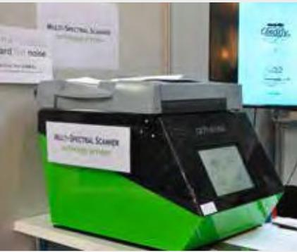
*Die Chemie der Farben macht es möglich: Der Multi-Spectral-Scanner von active-text kann beim Digitalisieren von Dokumenten bzw. der OCR-Aufbereitung Schwarztöne so gut unterscheiden, dass er unter geschwärzten Textstellen den Originaltext erkennt und Gekritzelt vom zu scannenden, gedruckten Text trennen kann.*
