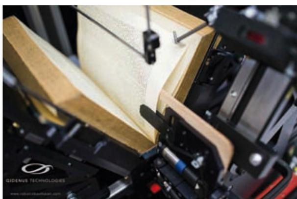
Abbildung 1: Die Blattwendevorrichtung und der Bionische Finger.
